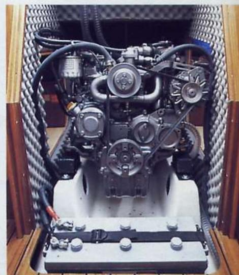
*Allo Yanmar da 48 cv si accede facilmente su tre lati. È consigliabile rendere stagna la batteria motore, ancora meglio spostarla.*
