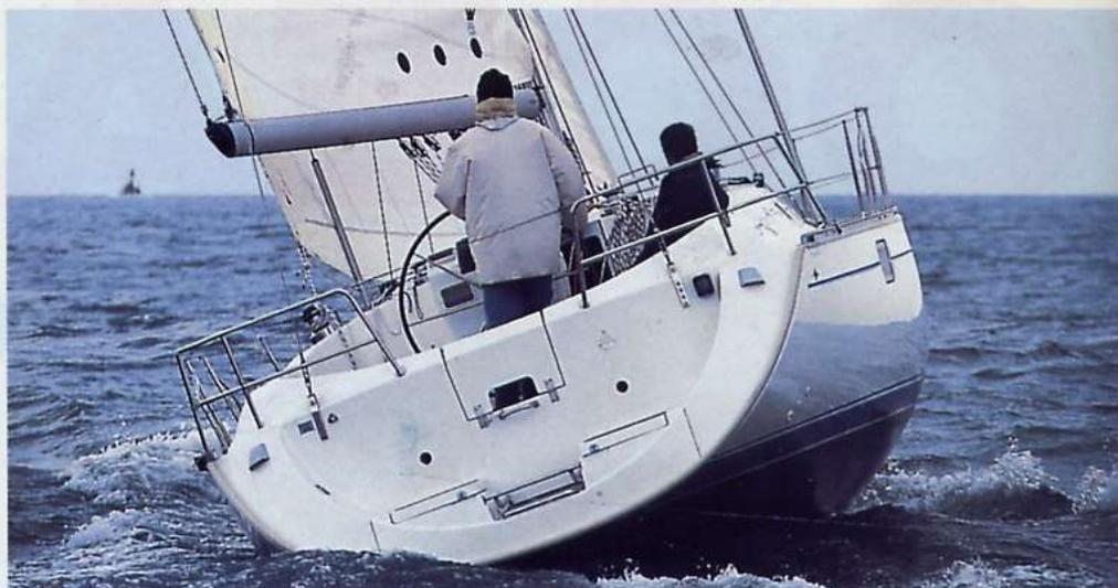
*La larghezza al galleggiamento è di poco inferiore al baglio massimo e questo conferisce all'Oceanis 400 una notevole stabilità di forma. Tale requisito è fondamentale su una barca da crociera, sia per il comfort di navigazione sia per limitare le manovre di riduzione delle vele.*
